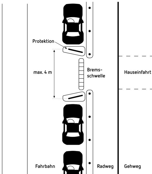
Beispiele für die Umsetzung baulicher Trennungen
